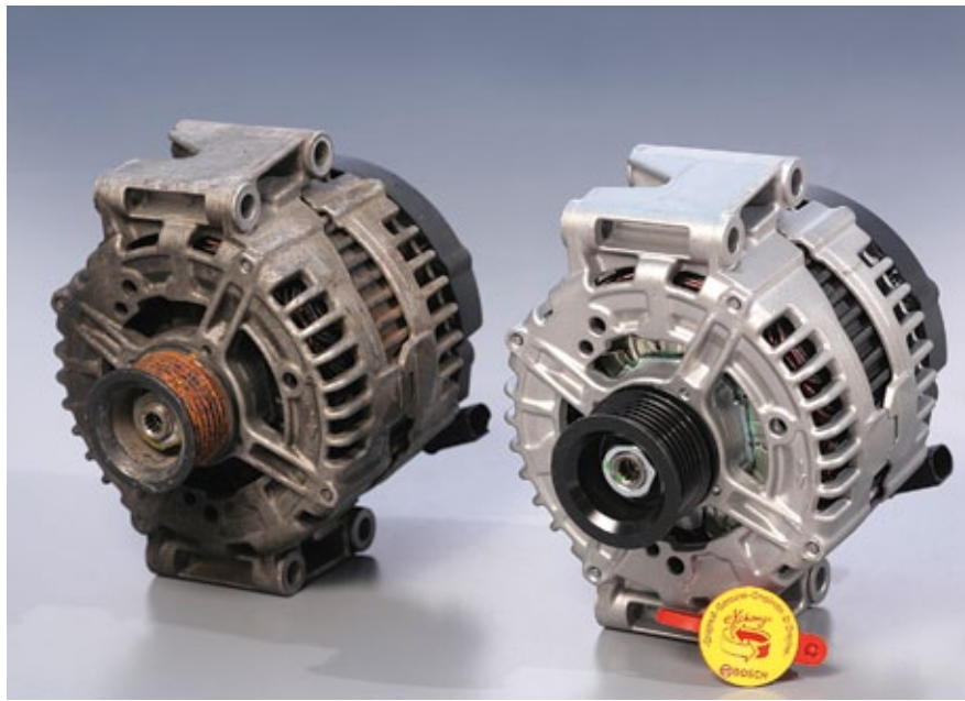
Генератор Bosch до и после восстановления.
