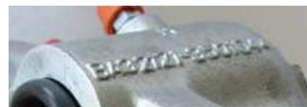
На алюминиевых корпусах передних тормозных цилиндров сохранена ВАЗовская маркировка
