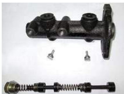
2108-2505010 цилиндр тормозов главный, раскрученного бренда. Конструкция изменена
