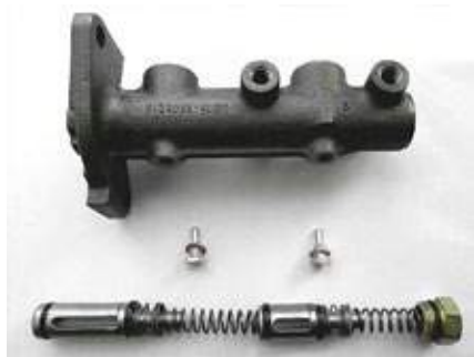
2108-3505010 цилиндр тормозов главный, производства «БРИК». Конструкция без изменений
