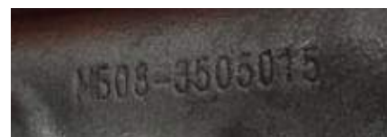
На чугунных корпусах в литье нанесена маркировка с буквами МБ (Миасс, БРИК)
