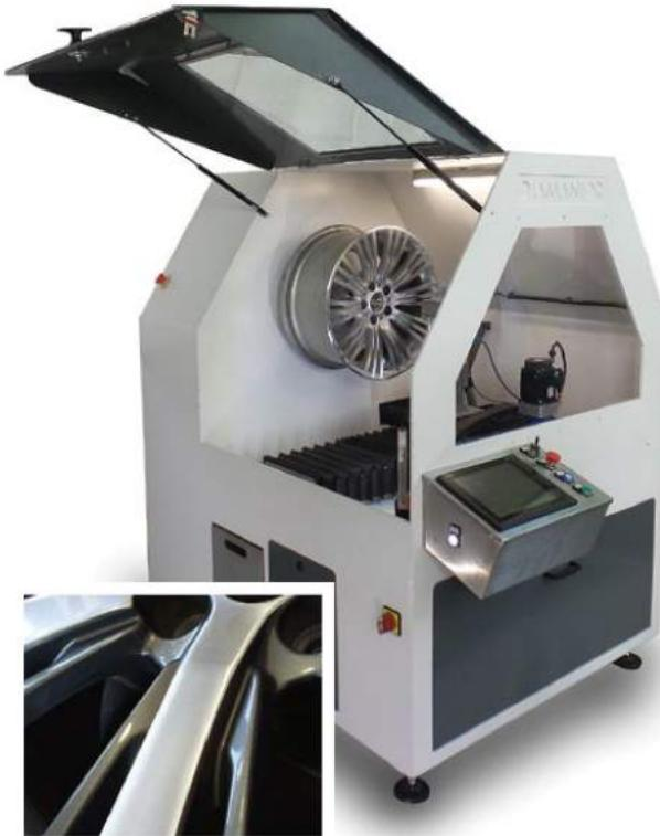
Уникальные характеристики оборудования Diamantor обеспечиваются двумя изобретениями господина Майе Филиппа, защищёнными патентами. Качество обработки настолько высоко, что ни визуально, ни с помощью балансировочного станка или весов не удается обнаружить разницы между новым и восстановленным дисками
